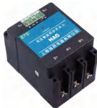
同步开关的原理，就是在电压过零点时刻投入磁保持继电器，于是就实现了电容器的无涌流投入。在电流过零点时刻切除磁保持继电器，于是就实现了电容器的无电弧切除。
